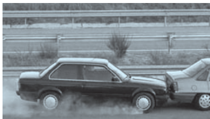
Figura. 1 Choque por alcance trasero entre vehículos (7)
