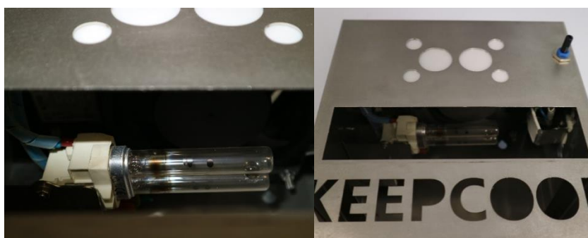
Figura 20. Ejemplo de lámpara de luz UV-C empleada durante la Tesis (izquierda) y su ubicación en el interior del sistema de eliminación de etileno (derecha).
