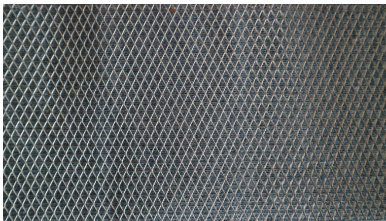
Figura 14. Ejemplo de malla de dióxido de titanio incorporada en el sistema de eliminación de etileno. Aplicado en estudios no publicados de la presente Tesis.
