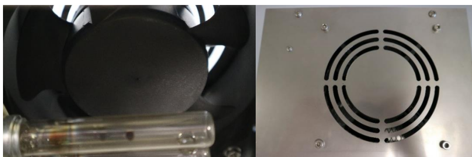
Figura 21. Ubicación del sistema de movimiento de aire (izquierda) y salida del aire libre de etileno (derecha).
