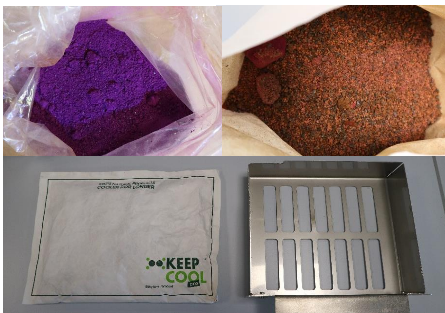
Figura 19. Imágenes del contenido de los filtros antes del uso (izquierda), después de su uso/agotamiento (derecha) y del propio filtro y la bandeja donde se ubica en el interior del sistema (abajo). Se puede ver claramente el cambio de color desde permanganato de potasio (color violeta) a óxido de manganeso (color marrón).
