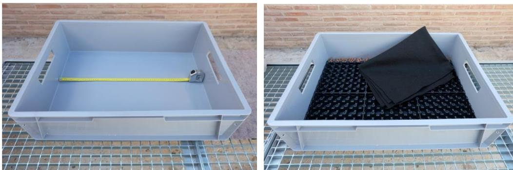
Figura 3.01. Imágenes del proceso inicial de instalación de las láminas drenantes en los módulos experimentales. Fuente: autor.
