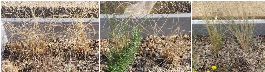
Figura 7.42. Resultados en 7,5 cm. Probeta 2 a 13 septiembre 2017 (izquierda). Probeta 4 a 13 septiembre 2017 (centro). Probeta 2 a 28 de abril 2018 (derecha). Fuente: autor.
