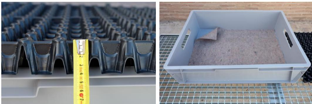
Figura 6.10. Capa de drenaje (izq.) Diadrain 40 y retenedora de agua VLS-500 (der.) de la marca Diadem. Fuente: autor.
