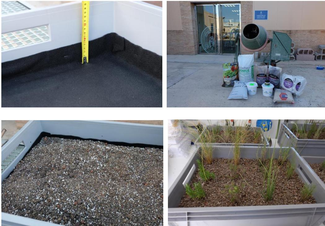
Figura 3.02. Imágenes del proceso inicial de instalación del sustrato y la vegetación en los módulos experimentales. Fuente: autor.
