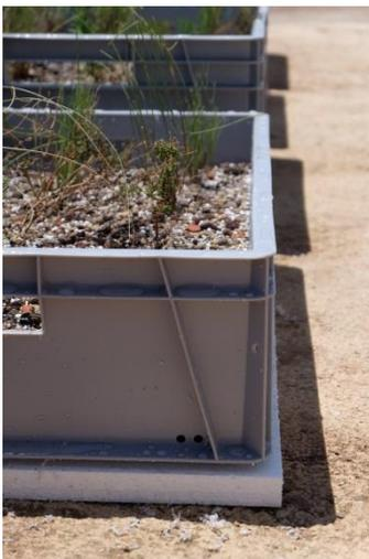
Figura 7.54. Salidas de evacuación del agua sobrante de los módulos a escala de cubierta vegetal. Fuente: autor.
