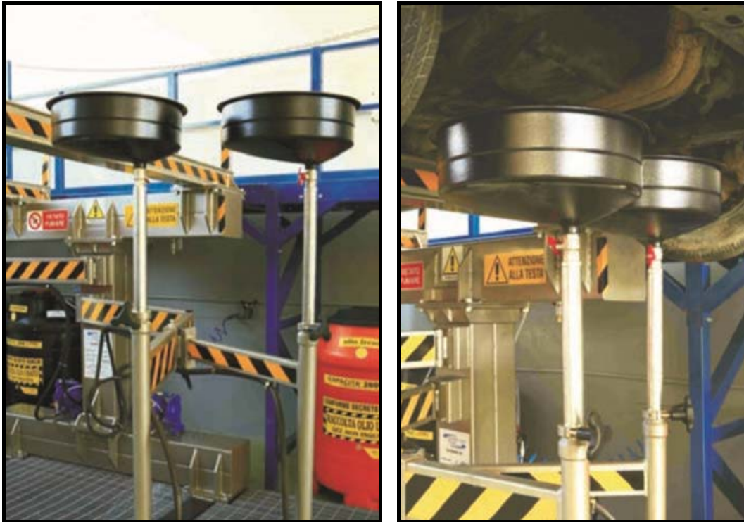
Imagen 5.9 y 5.10. Sistema de extracción de líquidos por gravedad (aceite, anticongelante y líquido de frenos. Fuente: FLEXBIMEC (2019).
