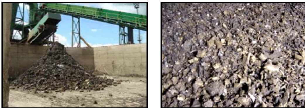
Imagen 5.19 y 5.20. Salida de residuo ligero en una fragmentadora y detalle. Fuente: SIGRAUTO (2012).
