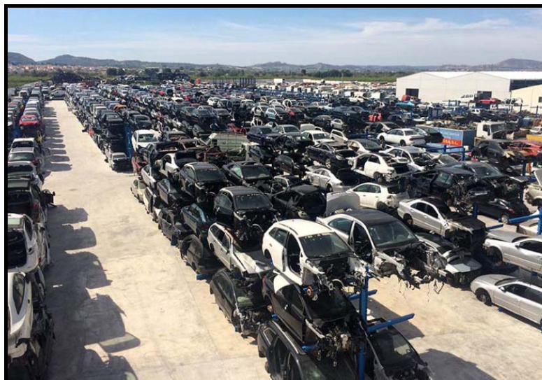
Imagen 5.5. Subzona de apilado sobre estructura metálica de almacenamiento de chasis. Fuente: Desguaces Mor, S.L. (2019).
