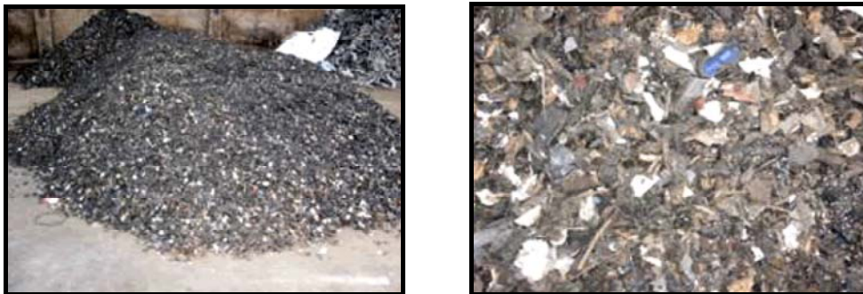
Imagen 5.21 y 5.22. Residuo pesado de fragmentadora sin metales y detalle. Fuente: SIGRAUTO (2012).
