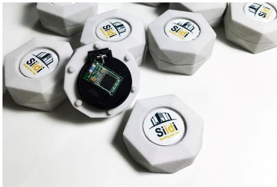
Figura 5. Beacon creados por HOPU para la Aplicación Experimental Siidi (OrganiCity Project, 2017a)
