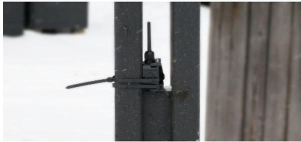
Figura 6. Beacons con encapsulado de exterior
