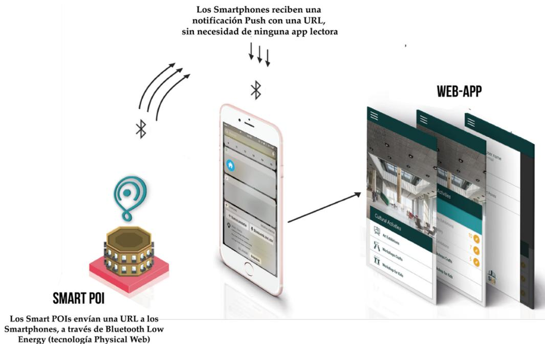
Figura 10. Funcionamiento del primer artefacto del Smart POI (HOP Ubiquitous S.L., 2017)
