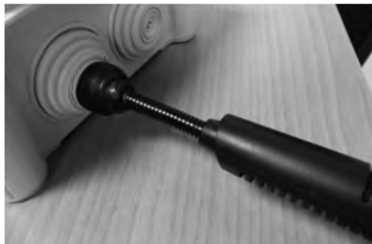
Figura 8. Micrófono electret en detalle.
