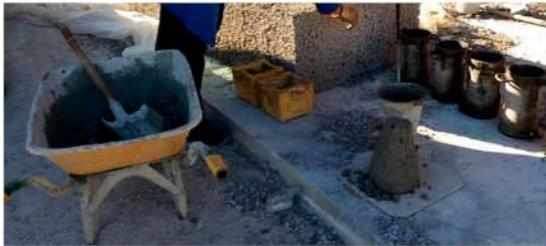
**Figura 2.** Ejecución del ensayo de Consistencia empleando cono de Abrams.
