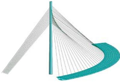
Figura 3: Modelo estructural de la pasarela del Malecón en Murcia.
