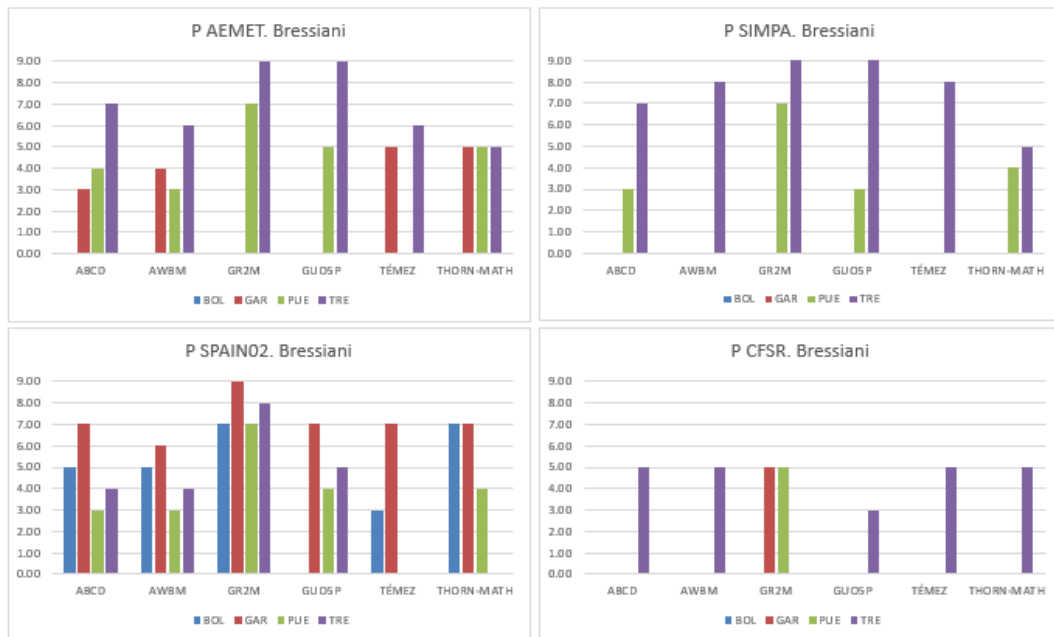
Figura 54. Índice RSR de los modelos de balance hídrico obtenidos a partir de la precipitación de diferentes fuentes climáticas y ETP SIMPA, para las cuencas BOL, GAR, PUE, TRE. Fuente: Elaboración propia.
