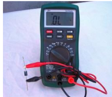
Medición de un diodo polarizado en forma inversa (no conduce)
