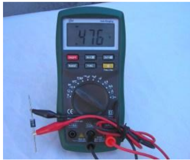
Medición de un diodo polarizado en forma directa (conduce)
